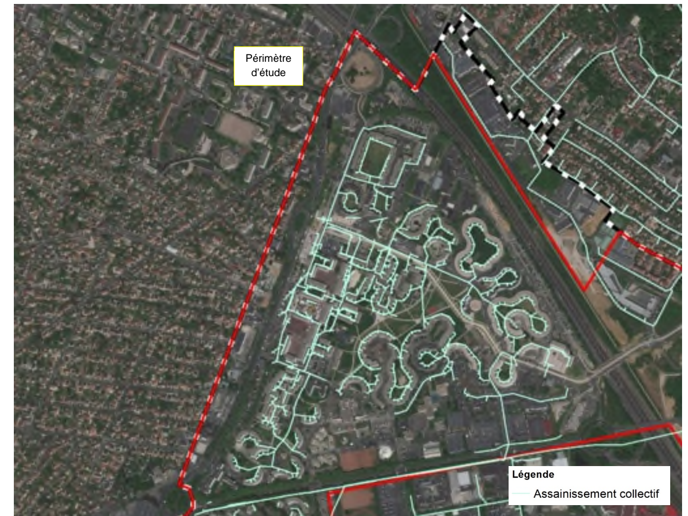
Figure 90 : Réseau d'assainissement au sein du périmètre d'étude
